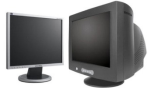
شاشة الكريستال السائل ضد شاشة إنبوب أشعة الكاثود
